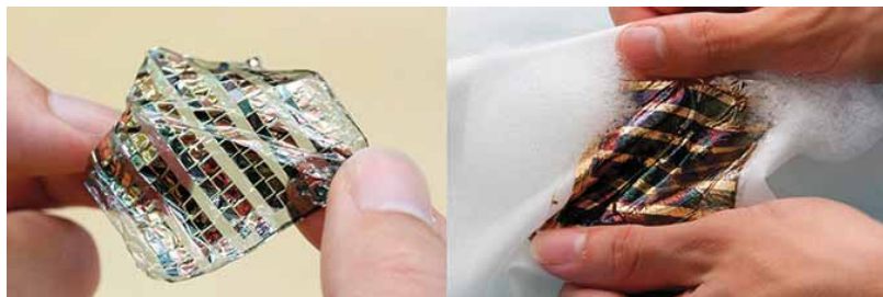
(左) 1マイクロ厚の高分子フィルム上に製造された超柔軟有機太陽電池 (右) 衣服上に貼り付けた超薄型有機太陽電池の洗濯写真
